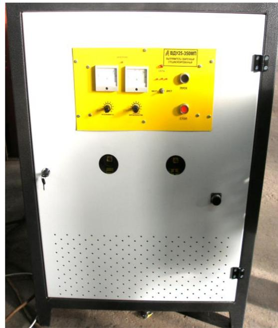
**Рис.2.** Источник сварочного тока для работы с удалёнными объектами
